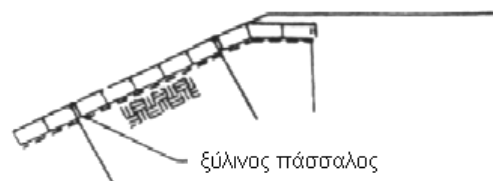
ΑΓΚΥΡΩΣΗ ΠΑΣΣΑΛΩΝ ΚΑΙ ΦΡΥΔΙΟΥ ΤΟΥ ΠΡΑΝΟΥΣ
