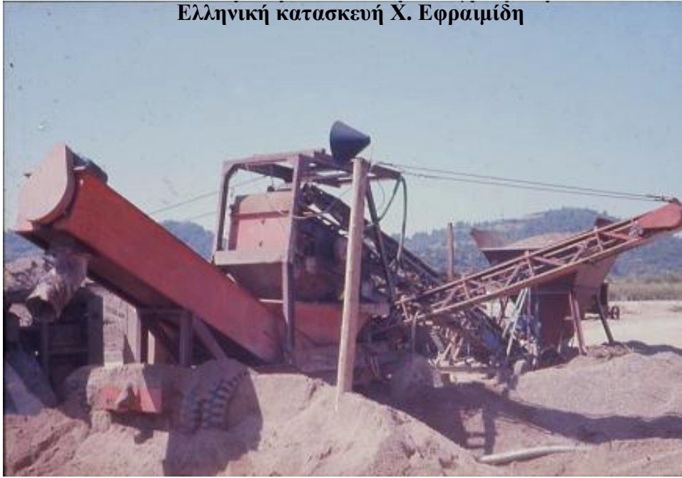
Εικόνα 4. Αυτοφερόμενο συγκρότημα πλύσεως και διαβαθμίσεως αδρανών υλικών και άμμου.
